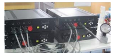
電力をパケット化して送受信するルータ
